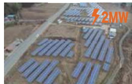
5 福島県・大熊町 2,003kW 7,704枚 2015年12月系統連系 ⚡2MW
